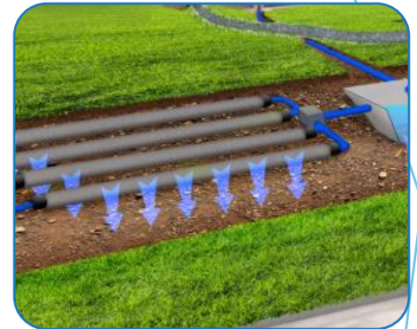
Trop-plein vers drain & massif d'infiltration
